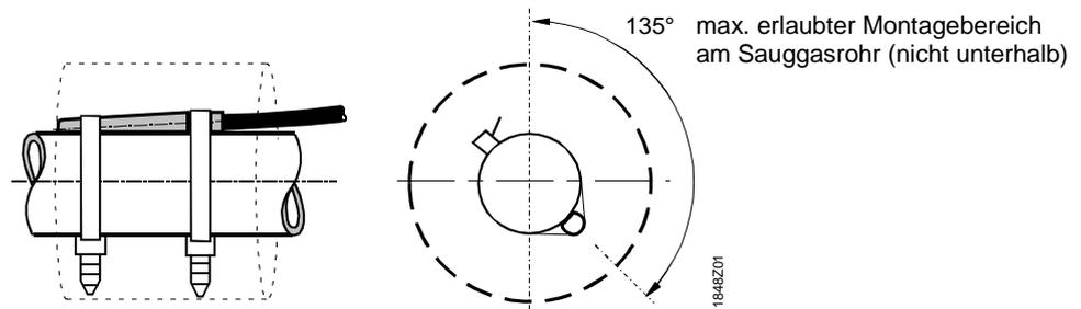
Der Fühler kann mit oder ohne Isolation montiert werden.
